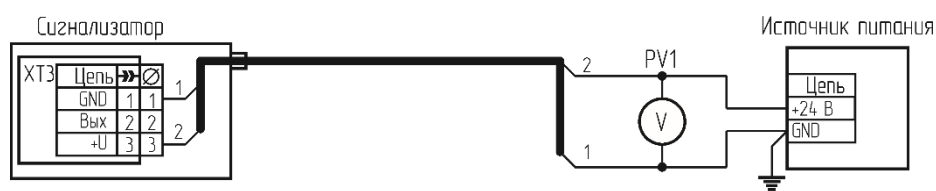
Рисунок Ж.1 – Схема включения сигнализатора СЗ-1ДЛВ-420К/24.
