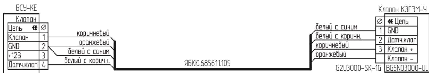
Рисунок А.1 – Типовая схема подключения клапана КЗГЭМ-У с разъемом BG5N03000-UL
