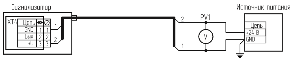
Рисунок Ж.2 – Схема включения сигнализатора СЗ-2ДВ-420/24.
