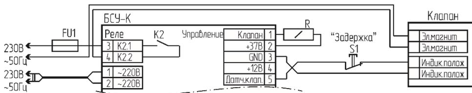
F – предохранитель (или автоматический выключатель) с рабочим током не более 2 А;
