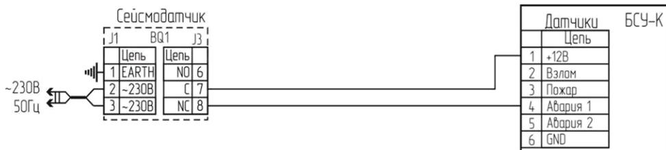
Рисунок Г.5 – Типовая схема подключения сейсмодатчика
