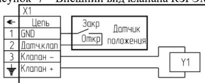
Рисунок 8 – Клапан КЗГЭМ-У. Схема электрическая принципиальная
