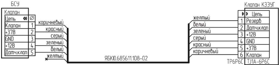
Рисунок Г.7 – Схема подключения клапана КЗЭУГ с разъемом Т11А-6Р6С.
