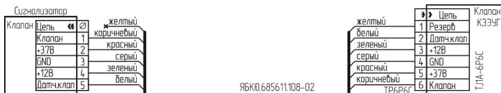
Рисунок В.2 – Схема подключения клапана КЗЭУГ с разъемом T1A-6P6C
