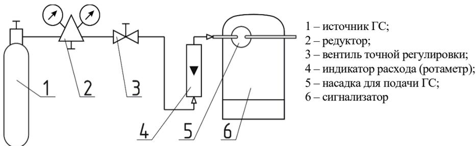
Рисунок Д.1 – Схема для настройки порогов срабатывания
