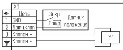
Рисунок 7 – Клапан КЗГЭМ-У. Схема электрическая принципиальная
