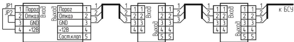
Рисунок Б.2 – Схема соединений сигнализаторов 2014 года выпуска.
