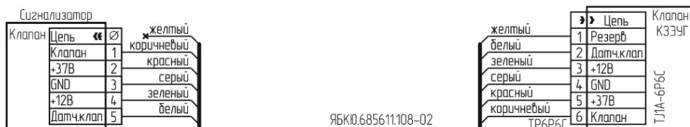
Рисунок В.2 – Схема подключения клапана КЗЭУГ с разъемом TJ1A-6P6C
