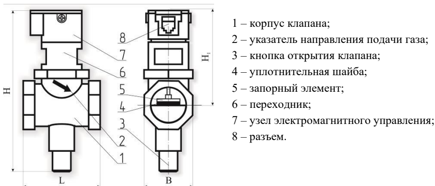
Рисунок 2 – Внешний вид клапана КЗЭУГ.
