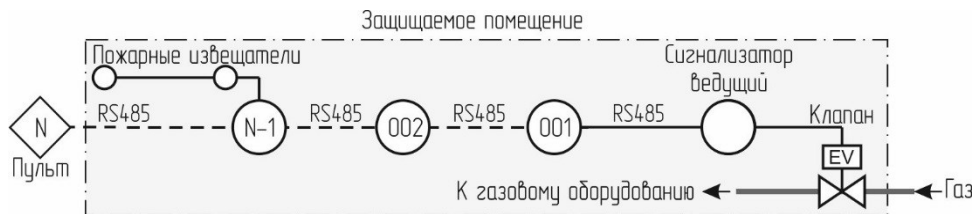
Рисунок 13 – Структура системы с RS485 и групповой защитой
