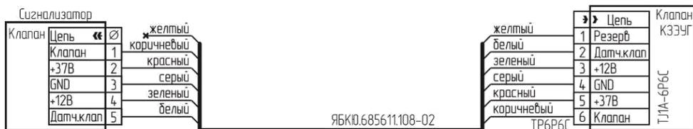
Рисунок Б.5 – Схема подключения клапана КЗЭУГ с разъемом ТТ1А-6Р6С.
