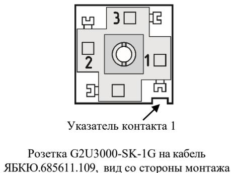
Рисунок Б.6 – Цоколевка разъемов кабелей.
