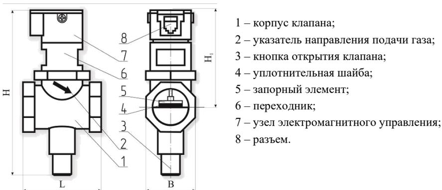
Рисунок 3 – Внешний вид клапана КЗЭУГ.
