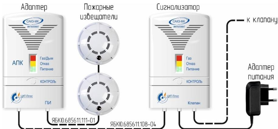
Рисунок Б.2 – Типовая схема подключения пожарных извещателей
