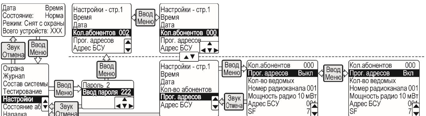
Рисунок 11 – Включение режима программирования адресов и обнуление количества абонентов
