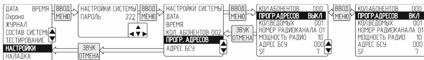
Рисунок 26 – Включение режима программирования адресов
