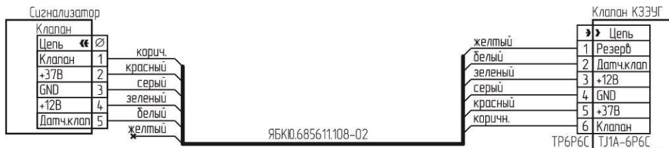
Рисунок В.4 – Схема подключения клапана КЗЭУГ с разъемом Т11А-6Р6С
