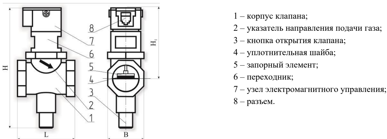
Рисунок 5 – Внешний вид клапана КЗЭУГ.
