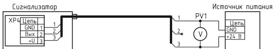
Рисунок Ж.2 – Схема включения сигнализатора СЗ-2ДВ-420/24.
