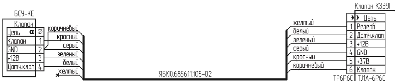
Рисунок А.2 – Типовая схема подключения клапана КЗЭУГ с разъемом TJ1A-6P6C
