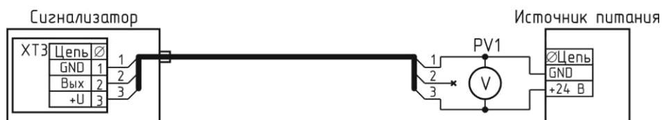
Рисунок Ж.1 – Схема включения сигнализатора СЗ-1ДЛВ-420К/24.
