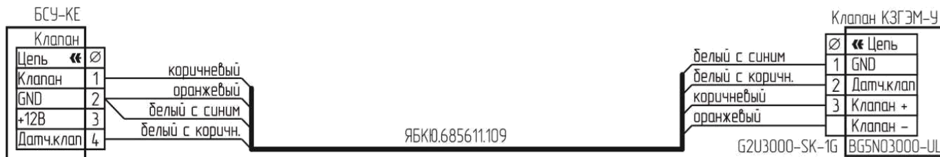
Рисунок А.1 – Типовая схема подключения клапана КЗГЭМ-У с разъемом BG5N03000-UL
