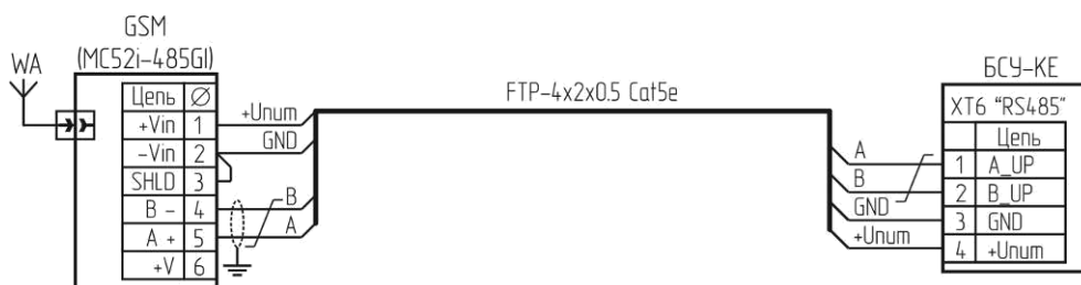
Рисунок Г.2 – Схема подключения GSM-извещателя MC52i-485GI.
