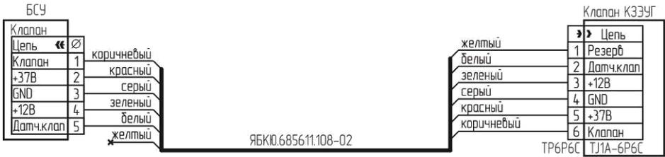
Рисунок Г.7 – Схема подключения клапана КЗЭУГ с разъемом ТJ1А-6Р6С.
