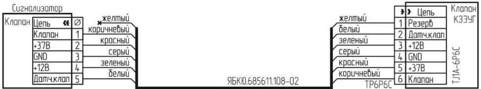
Рисунок В.2 – Схема подключения клапана КЗЭУГ с разъемом Т11А-6Р6С
