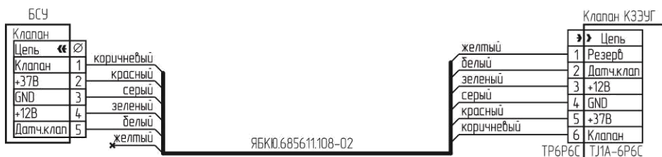
Рисунок Б.5 – Схема подключения клапана КЗЭУГ с разъемом Т11А-6Р6С.
