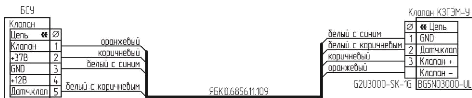
Рисунок Б.4 – Схема подключения клапана КЗГЭМ-У с разъемом BG5NO3000-UL.
