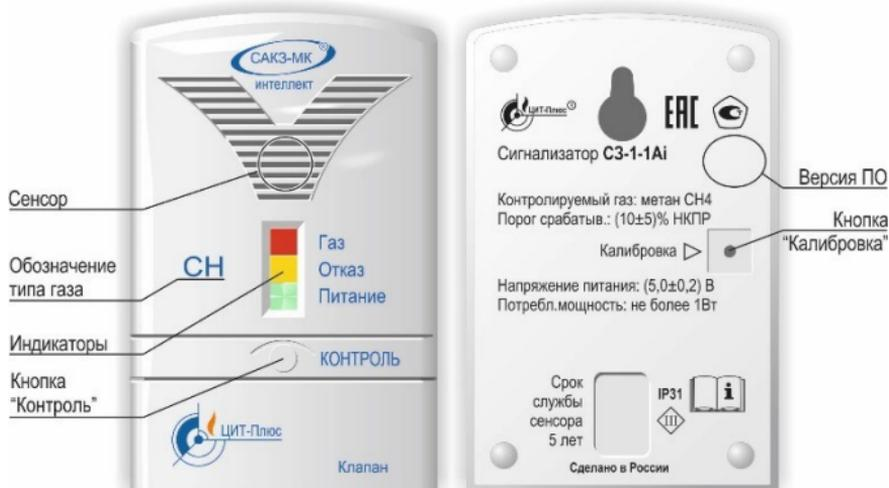
Рисунок 1 – Внешний вид сигнализатора
