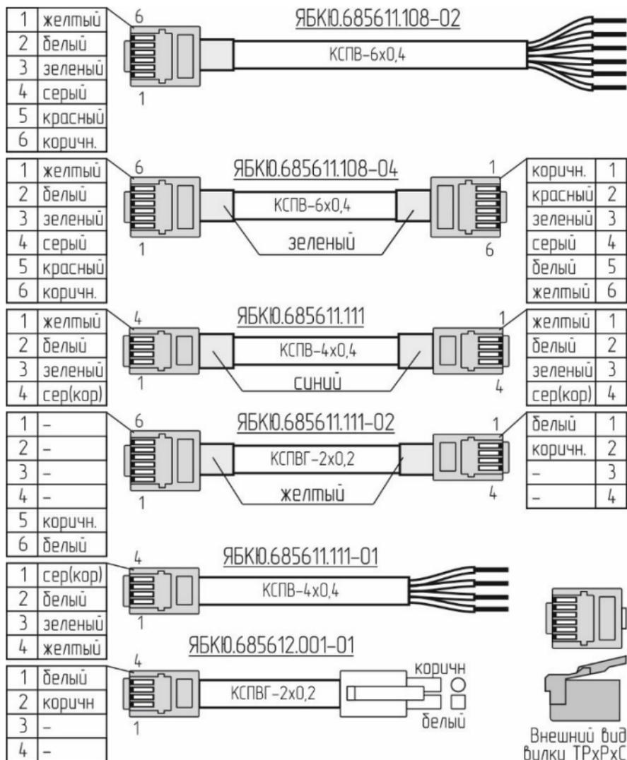
Рисунок Б.6 – Цветовая маркировка проводов кабелей
