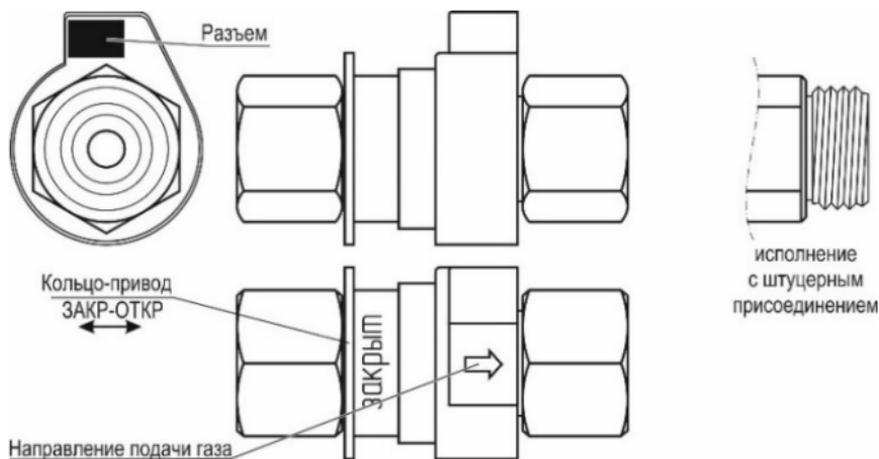
Рисунок 4 – Внешний вид клапана типа КЗЭУГ-Б
