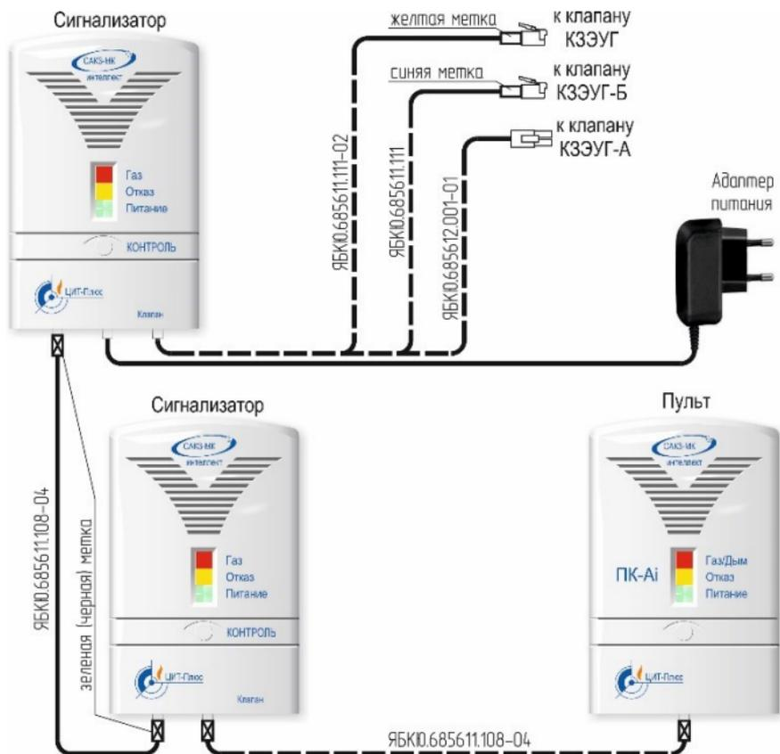
Рисунок Б.1 – Типовая схема соединений
