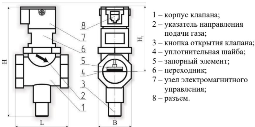
Рисунок 2 – Внешний вид клапанов КЗЭУГ
