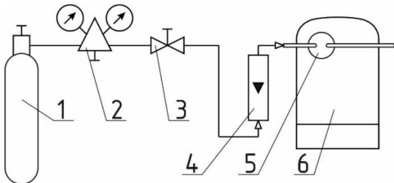
1 – источник ГС; 2 – редуктор с вентилем точной регулировки (для ГС в баллонах под давлением); 3 – вентиль точной регулировки (при использовании ГС в баллонах под давлением); 4 – индикатор расхода (ротаметр); 5 – насадка для подачи ГС; 6 – сигнализатор
