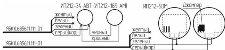
Рисунок Б.3 - Схема электрическая подключения пожарных извещателей
