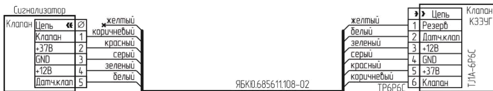
Рисунок Б.5 – Схема подключения клапана КЗЭУГ с разъемом TJ1A-6P6C.
