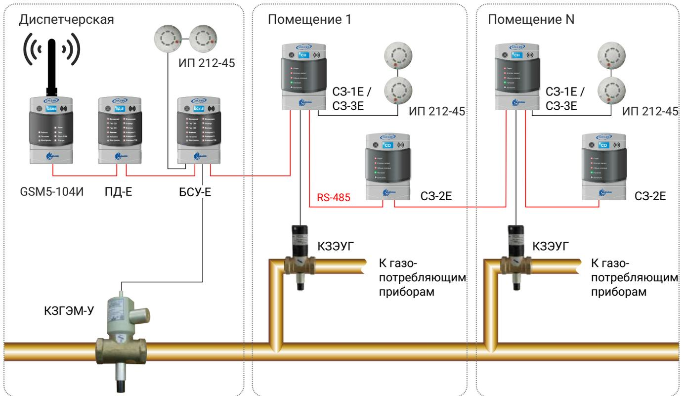
**САК3-МК®-2Е: схема с проводным интерфейсом RS485 с общим отсечным клапаном и индивидуальной защитой**
