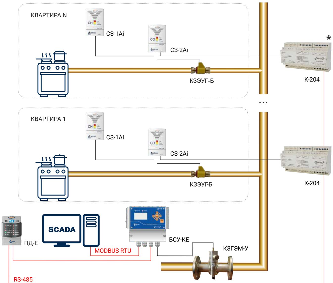
Примечание \* - каждое устройство К-204 имеет 4 выхода для подключения СЗ-Аi. Для К-204 в исполнении -01 необходимы источники питания 24В
