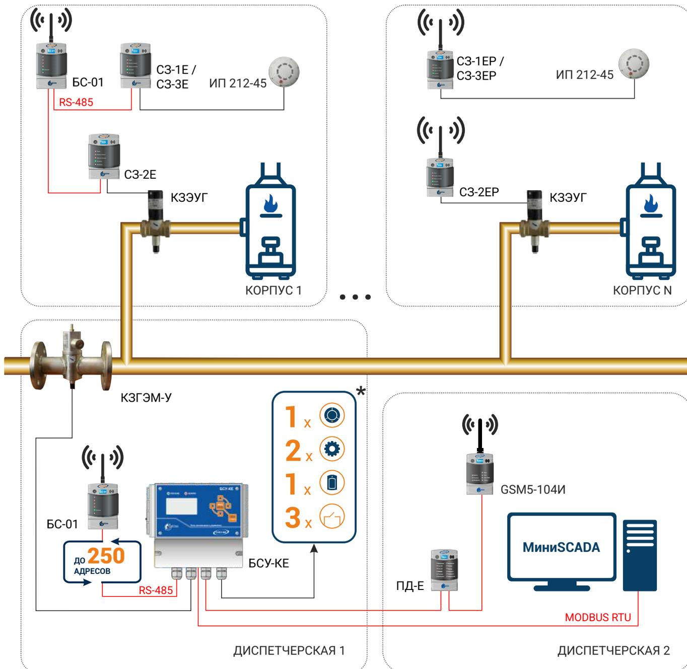
Примечание \* - 1 шлейф пожарной сигнализации, 2 шлейфа технологических датчиков (датчики аварий), 1 шлейф охранной сигнализации, 3 выхода реле «сухой» контакт
