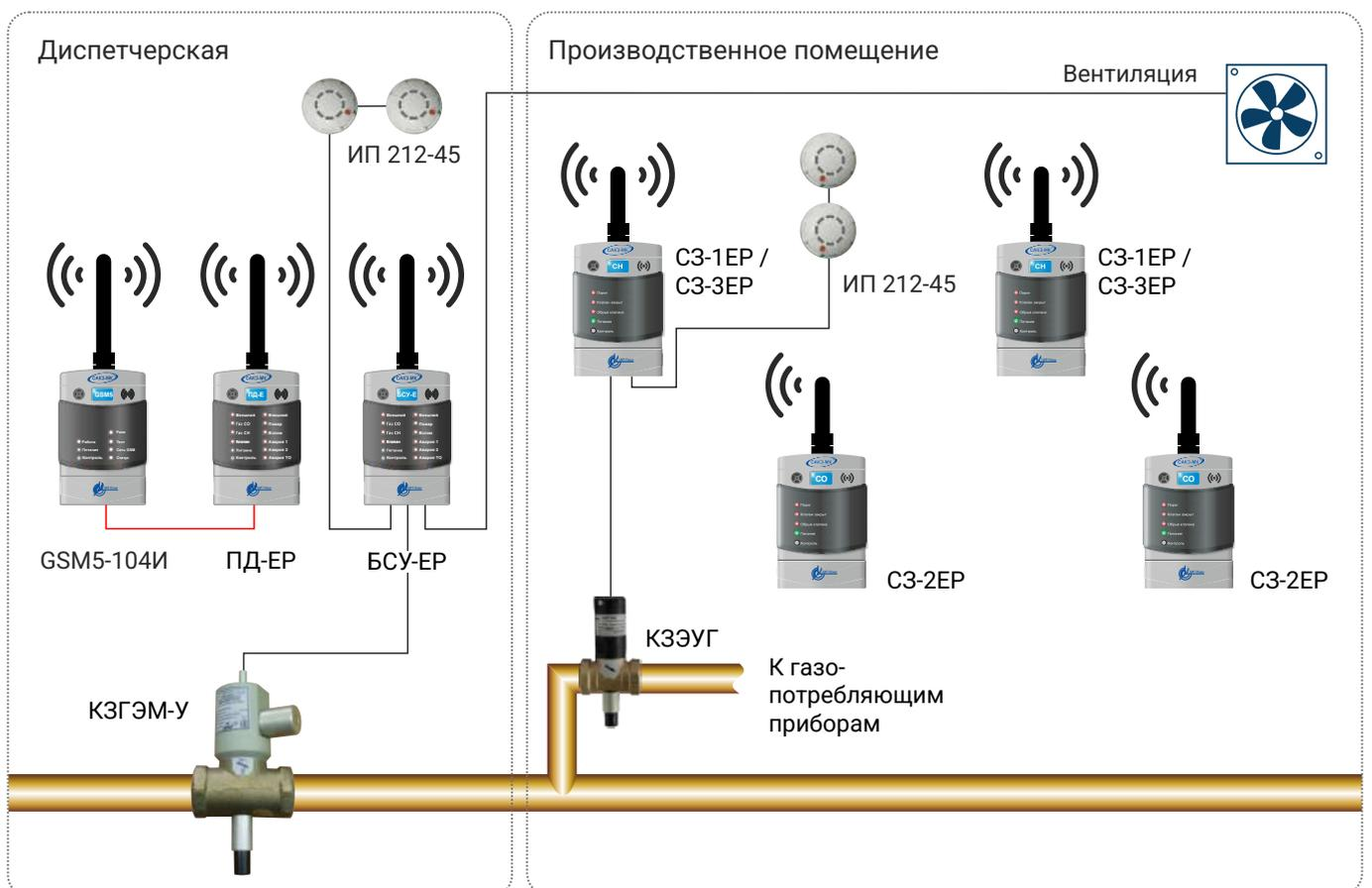
**САК3-МК®-2Е: схема радиоканального решения с отсечным клапаном и групповой защитой**
