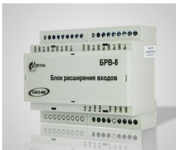
**Блок расширения входов БРВ-8** предназначен для согласования дискретных сигналов с интерфейсом RS485 по командам от устройства-«мастера» по протоколу Modbus RTU.
