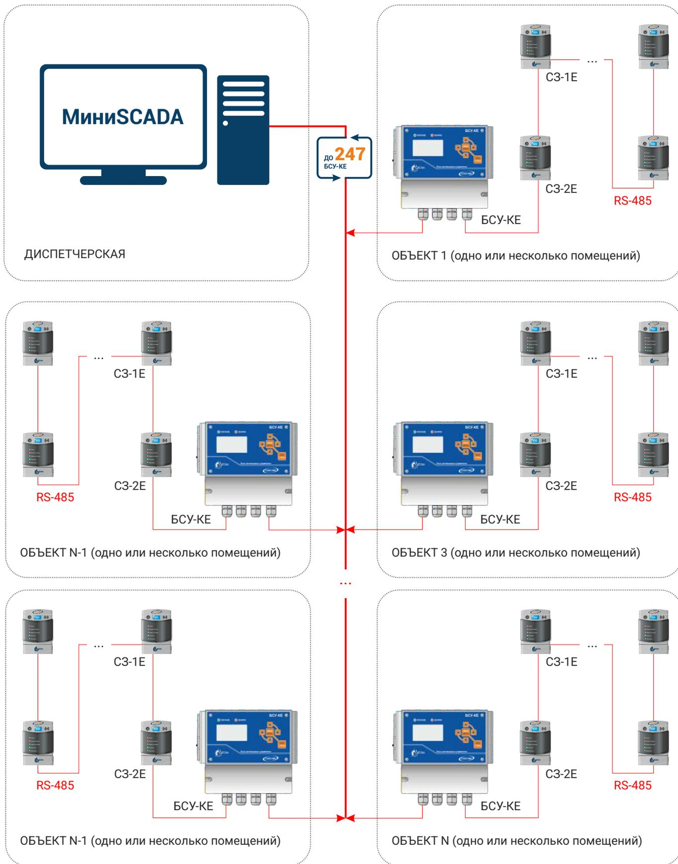
Единая система мониторинга безопасности газопотребления на распределенном объекте на базе систем САКЗ-МК®-3Е с использованием ПО «МиниSCADA»
