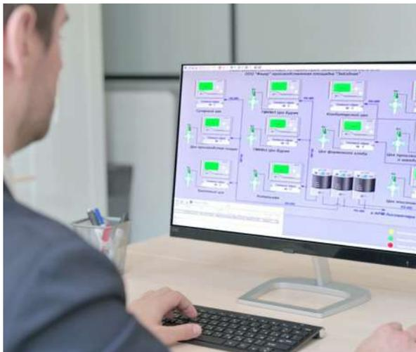
Программное обеспечение «МиниSCADA» предназначено для создания мониторинга и настройки систем автоматического контроля загазованности САКЗ-МК® серии «Е».
