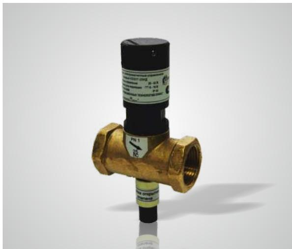
**Клапан запорный с электромагнитным управлением газовые КЗЭУГ предназначен** для использования в помещениях потребителей газа в качестве запорного элемента трубопроводных магистралей с рабочей средой в виде природного газа с рабочим давлением до 0,005 МПа (0,05 кгс/см<sup>2</sup>).
