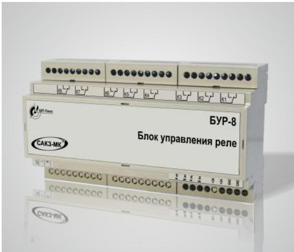
**Блок управления реле БУР-8** предназначен для формирования сигналов типа «сухой переключающий контакт» по командам от устройства – «мастера» по интерфейсу RS485. Блок может применяться в системе автоматического контроля загазованности САКЗ-МК®-3Е и других системах автоматизированного и автоматического управления.
