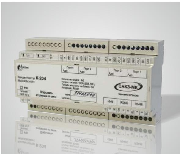
**Концентратор К-204** предназначен для преобразования дискретных входных сигналов в пакеты данных для последующей передачи их по интерфейсу RS485 (протокол ModBUS/RTU).
