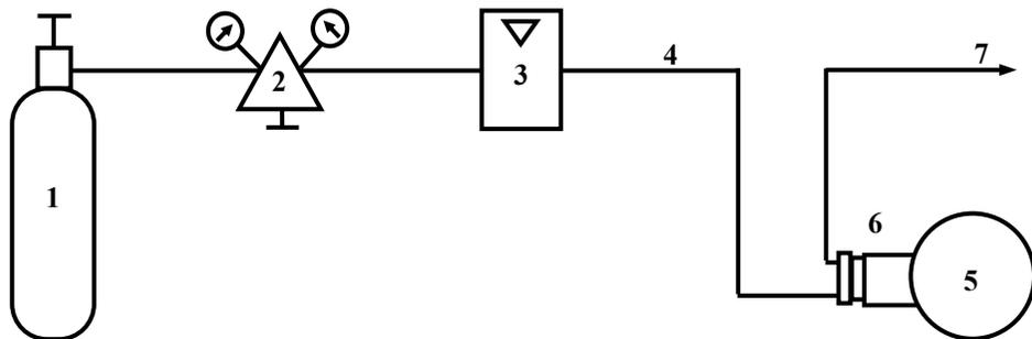
1 – баллон с ГС; 2 – редуктор; 3 – ротаметр; 4 – трубка; 5 – сигнализатор;
