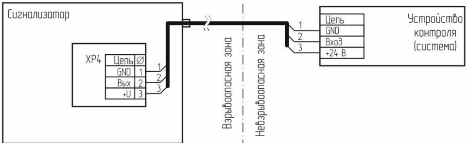
Рисунок Д.1 – Схема включения сигнализатора
