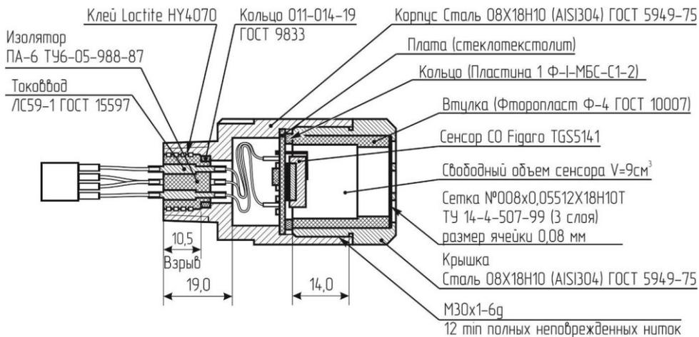
1 Взрывонепроницаемость сенсора обеспечивается заключением чувствительного элемента во взрывонепроницаемую оболочку, состоящую из корпуса и крышки, образующих взрывонепроницаемое соединение.
