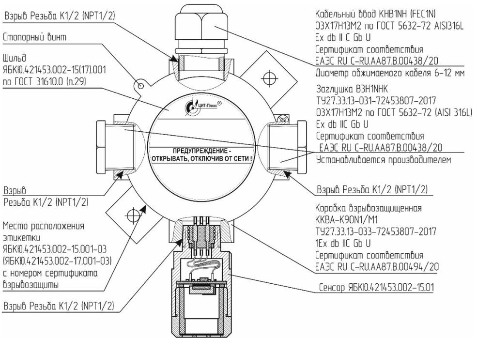
1 Для подведения питания применен кабельный ввод КНВ1NH (FEC1N) Ex d IIC Gb U. Для герметизации ввода применены втулки из эластичного материала из комплекта кабельного ввода.
