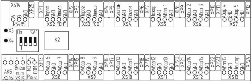
Рисунок Б.1 – Расположение элементов в клеммном отсеке
