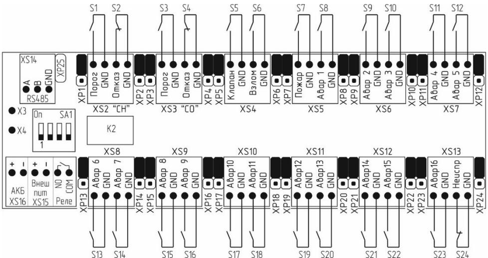
Рисунок 2 – Типовая схема подключения извещателя и положение переключателей
