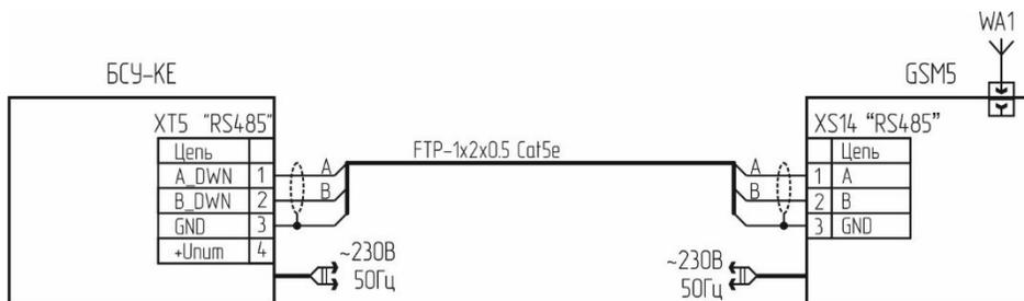
Рисунок 6 – Схема подключения для программирования адреса
