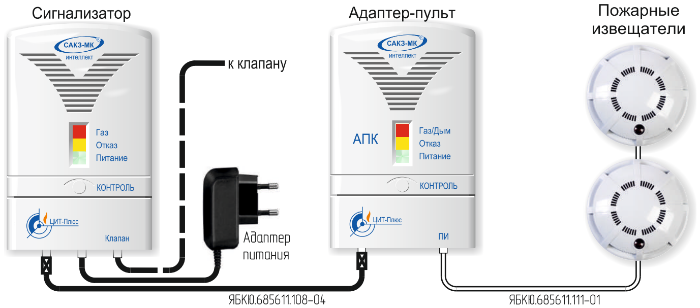
Типовая схема соединений САКЗ-МК®-1-1Ai с пожарными извещателями
