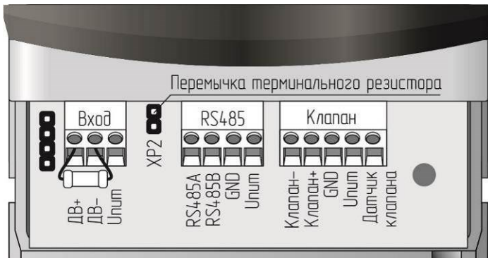
Рисунок В.2 – Расположение разъемов сигнализатора СЗ-3Е-485(Р).
