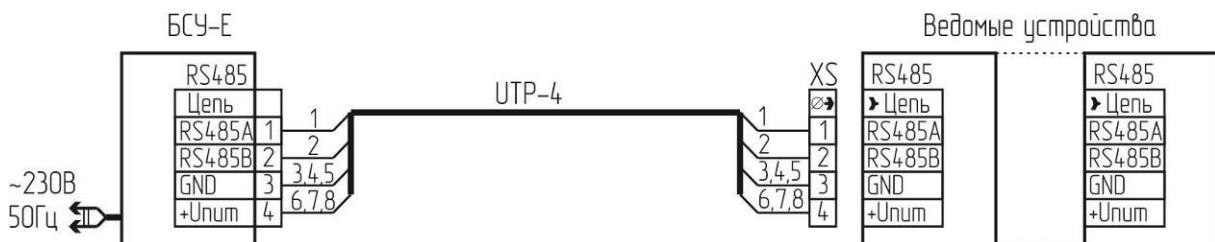
XS – клеммник 15EDGK-3,5-04P (кабельная часть, установлен в разъем “RS485”)
