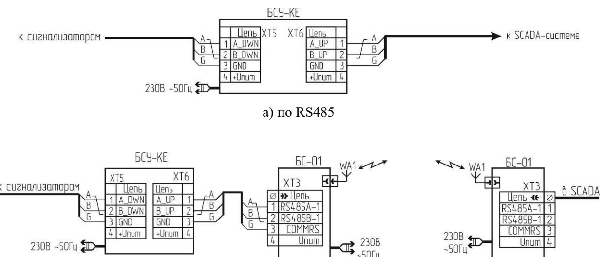
Адрес BC-01 присваивается в последнюю очередь, при этом разъем XS (см. рисунок 10) подключается к разъему XT3 (RS485-1) BC-01.
