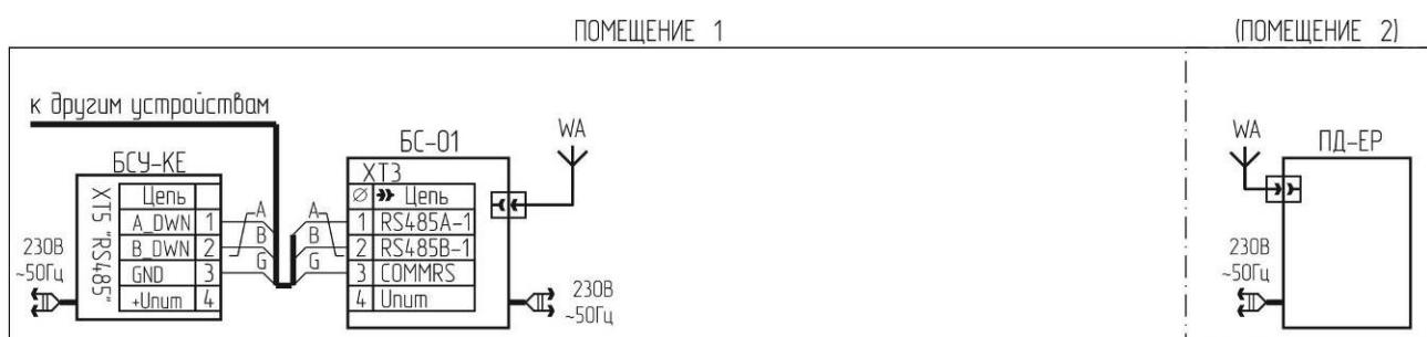
Рисунок 18 – Схема подключения удаленного пульта ПД-ЕР.
