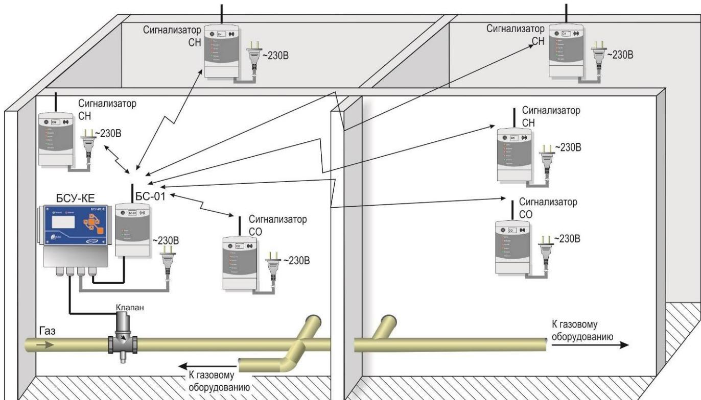
Рисунок А.2 – Пример схемы размещения с радиоканалом.
