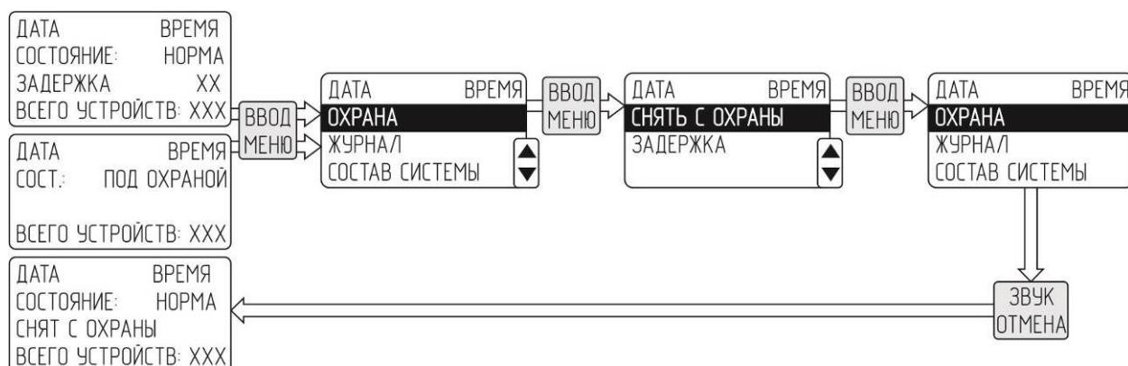
Рисунок 8 – Порядок действий для отключения режима охраны.
