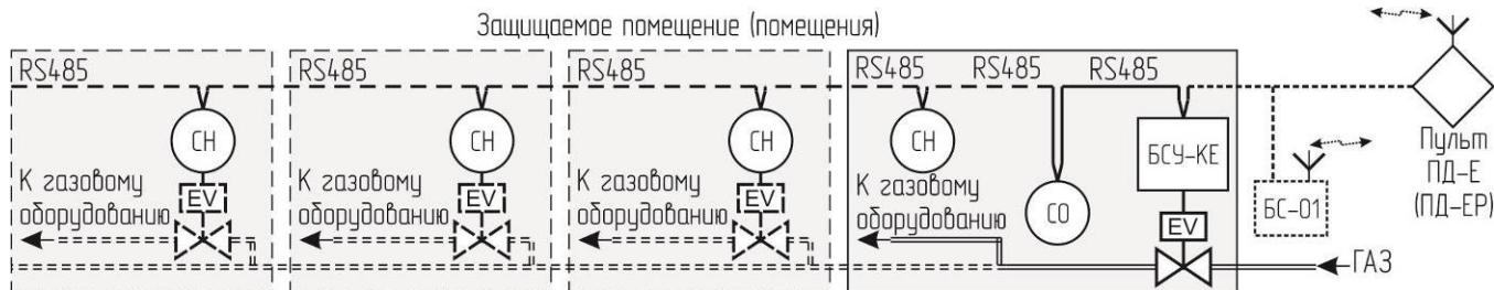
Рисунок 12 – Структура системы с интерфейсом RS485.
