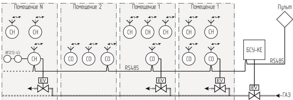
Рисунок 16 – Структура системы с групповой защитой.
