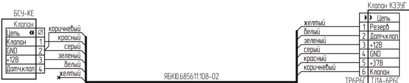
Рисунок Г.4 – Типовая схема подключения клапана К3ЭУГ с разъемом TJ1A-6P6C
