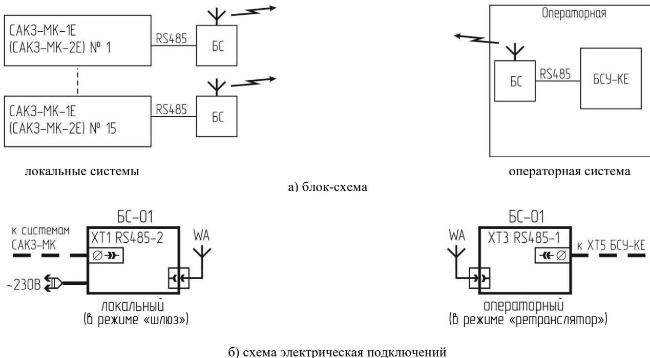
Рисунок 22 – Подключение нескольких систем (САКЗ-МК-1Е, САКЗ-МК-2Е) к БСУ-КЕ по радиоканалу с использованием блоков БС-01.
