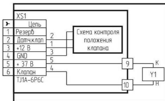
Рисунок 4 – Клапан КЗЭУГ. Схема электрическая принципиальная.
