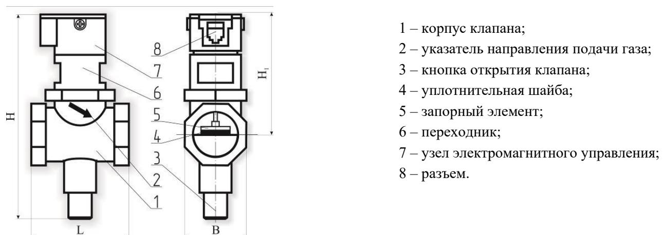
Рисунок 3 – Внешний вид клапана КЗЭУГ.
