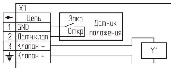
Рисунок 6 – Клапан КЗГЭМ-У. Схема электрическая принципиальная.
