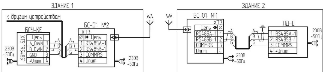
Рисунок 19 – Схема подключения удаленного пульта ПД-Е
