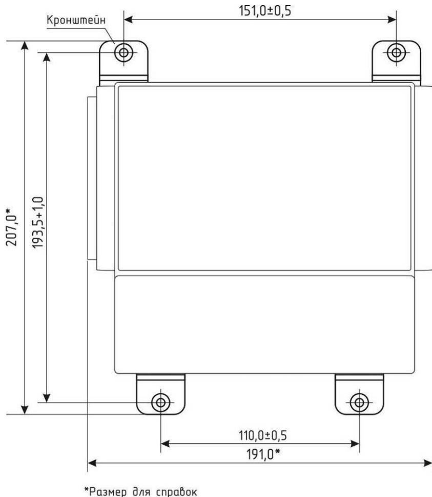
Рисунок В.1 – Разметка отверстий
