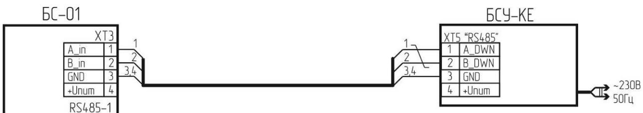
Рисунок 26 – Схема для программирования адреса БС-01
