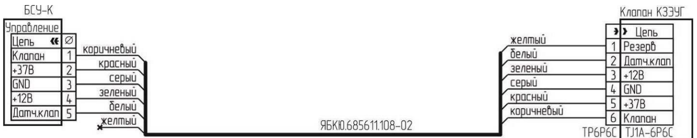
Рисунок В.7 – Типовая схема подключения клапана КЗЭУГ с разъемом TJ1A-6P6C
