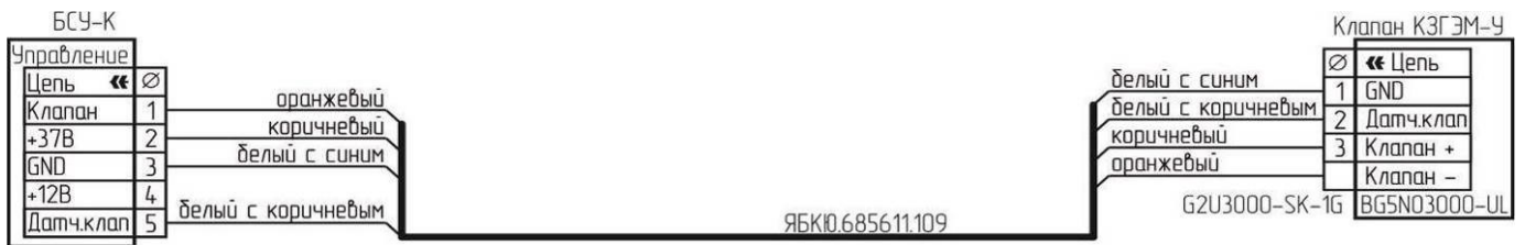
Рисунок В.6 – Типовая схема подключения клапана КЗГЭМ-У с разъемом BG5N03000-UL
