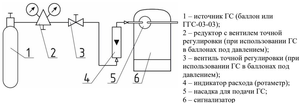
Рисунок Г.1 – Схема для настройки порогов срабатывания
