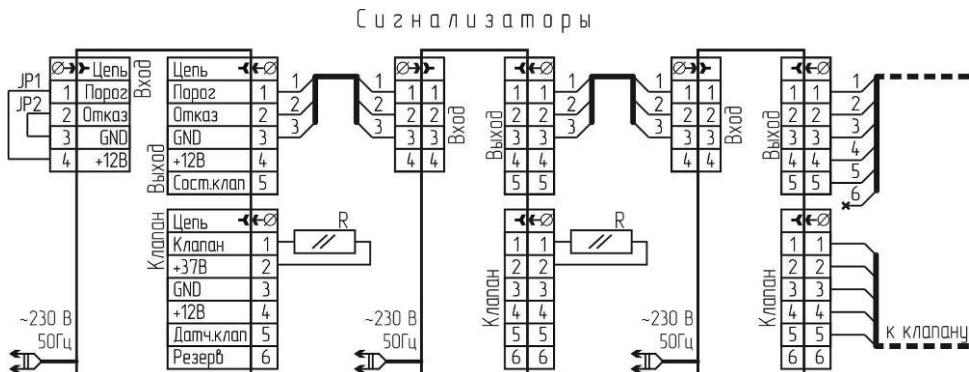
Рисунок Б.3 – Схема соединений сигнализаторов без разъема «Upit».
