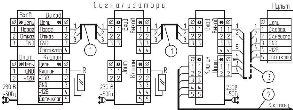
Рисунок Б.1 – САКЗ-МК-1. Типовая схема соединений.
