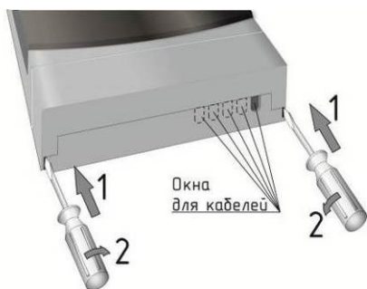
Рисунок 2 – Снятие крышки клеммного отсека
