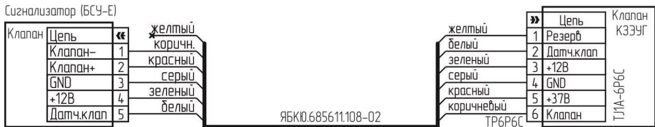
Рисунок В.2 – Схема подключения клапана КЗЭУГ с разъемом TJ1A-6P6C
