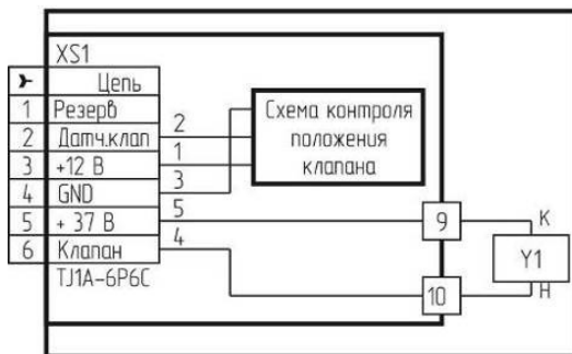
Рисунок 3 – Клапан КЗЭУГ. Схема электрическая принципиальная.
