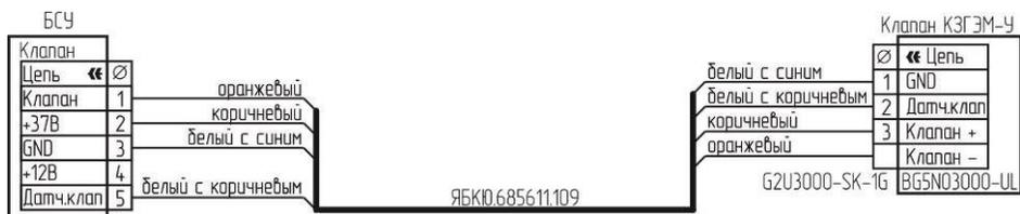
Рисунок Б.4 – Схема подключения клапана К3ГЭМ-У с разъемом BG5N03000-UL.
