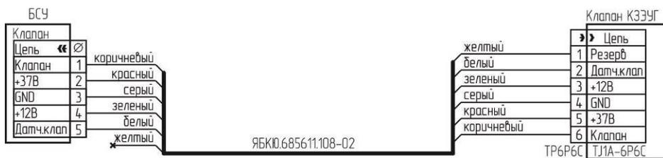
Рисунок Б.5 – Схема подключения клапана К3ЭУГ с разъемом ТJ1А-6P6C.
