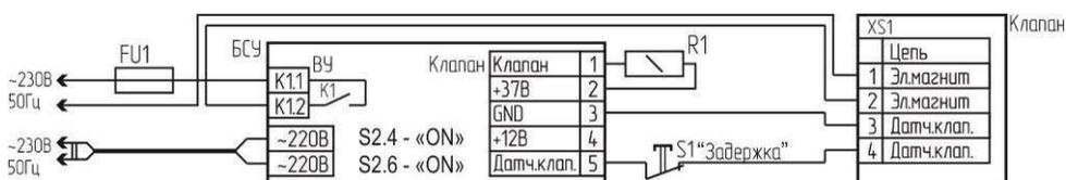
в) схема подключения клапана типа MADAS EVPS
