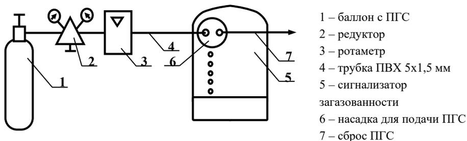
Рисунок Е.1 – Схема для настройки порогов срабатывания
