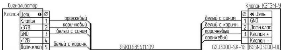
Рисунок Б.4 – Схема подключения клапана КЗГЭМ-У с разъемом BG5N03000-UL.
